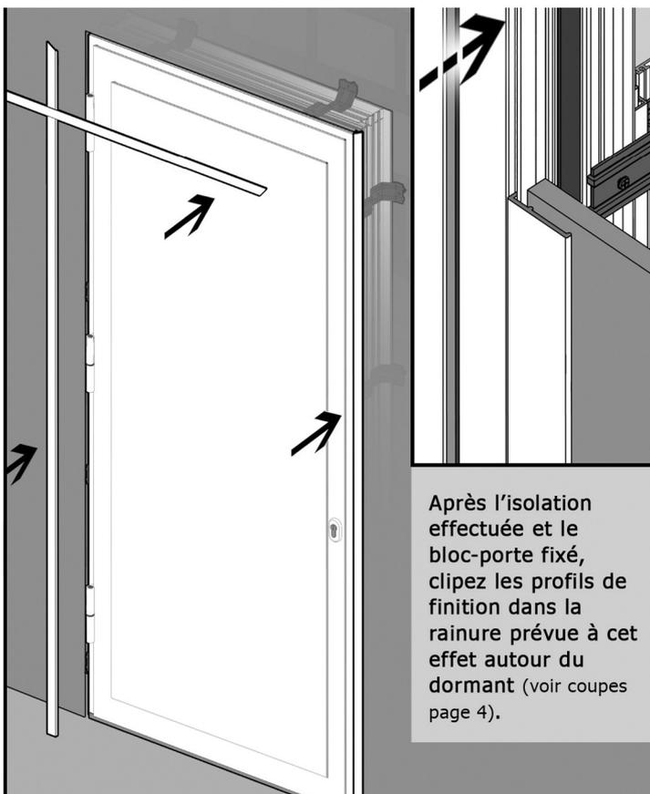
Après l'isolation effectuée et le bloc-porte fixé, clipsez les profils de finition dans la rainure prévue à cet effet autour du dormant (voir coupes page 4).
