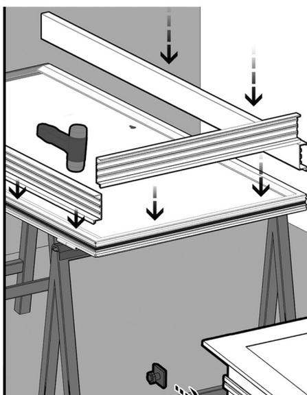
Insérer les clameaux dans le profilé de la tapée et les glisser jusqu'aux points de vissage des équerres de fixation.
