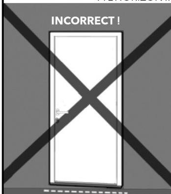
Mettre le seuil de la porte de niveau à l'aide de cales et de silicone.
