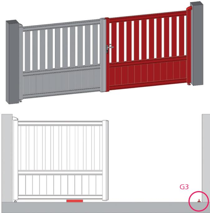
☐ Positionnez votre vantail sur une cale de 35 mm, puis réalisez les tracés pour les perçages  $\varnothing 14$
