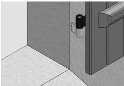
Attention : la pose du convertisseur rehausse le vantail d'environ 2 mm.
