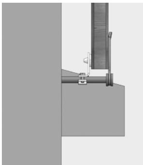
1. Desserrer les vis de la butée à l'aide du tournevis.
