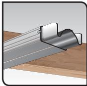
1. Insérer le raccord de fourrure dans l'extrémité de la fourrure.
