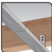
2. Passer la seconde fourrure sous le raccord de fourrure.
