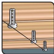
2. Aligner les suspentes grâce à l'encoche prévue à cet effet, conformément aux dimensions des plaques de plâtre et au sens de l'ossature.
