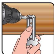
1. Fixer les suspentes avec 2 vis en bordure de charpente, perpendiculairement au chevron.
