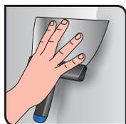
1. Appliquer une couche de colle enduit joint plaque de plâtre sur le raccord des deux plaques de plâtre (Bords amincis ou droit).
