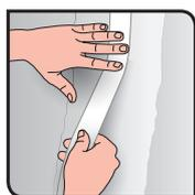
2. Appliquer la bande à joint papier sur la colle enduit précédemment appliquée sur la longueur des raccords et serrer avec le couteau à enduire (bien plaquer la bande sur l'enduit).
