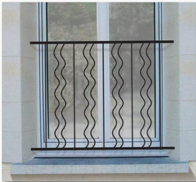
Main courante en tube rectangle 50x30x2, lisse basse en tube 30x30x2, barreaux en carré plein 12x12.
