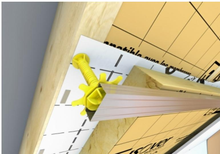
Suspente en composite technique composé constitué : › d'une tige à visser sur la charpente › d'une clé à ailettes sur laquelle est clipsée l'ossature métallique
