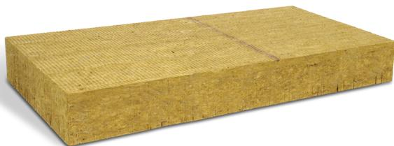
Panneau double densité non revêtu, utilisé pour l'isolation par l'extérieur sous vêtements ou vêtages. Face surdensifiée repérée par un marquage.
