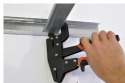
Pour sertir tous types de rails et montants, lisses et fourrures F530. Utilisation à 1 main sans effort grâce à son système de crémaillère (3 crans pour que le poinçon arrive en contact sur le rail et 1 cran et demi pour sertir).
