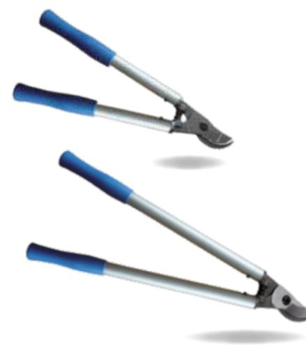
Permet de tailler et d'élaguer les grosses branches et les pieds de vigne. Prolongement de la soie de la lame et de la contre-lame dans le manche pour plus de résistance. Lame et contre-lame en acier forgé. Modèle déposé.
