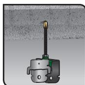
1. Insérer la tige filetée  $\varnothing 6$  préalablement installée dans la suspenste acoustique et bloquer avec un écrou.
