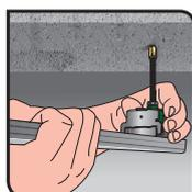
2. Emboîter les suspentes acoustiques dans les supports (fourrures) et faire glisser le dispositif de sécurité, le support et la suspenste étant alors totalement rattachés.
