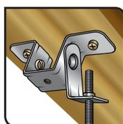
1. Fixer la suspente sur le chevron en sous pente avec des vis > 25 mm. Positionner la tige filetée d=6mm dans le "L" mobile à la verticale et maintenue par l'écrou.
