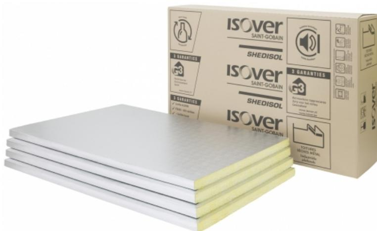
Panneau en laine de verre rigide revêtu d'un pare-vapeur et d'un revêtement kraft aluminium gaufré sur une face, renforcé de 2 voiles de verre et rebordé sur 2 côtés
