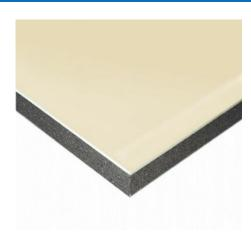
Complexe de doublage constitué d'un panneau isolant en polystyrène expansé (PSE) graphité, associé à une plaque de plâtre Placo®. Parement plaque de 13 mm permettant utilisation en ERP. Ancien libellé: Placomur® Ultra 32 13+100.
