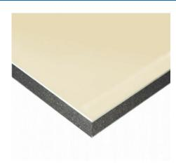
Complexe de doublage constitué d'un panneau isolant en polystyrène expansé (PSE) graphité, associé à une plaque de plâtre Placo®. Parement muni d'un film pare-vapeur, à haute résistance à la diffusion de la vapeur d'eau.
