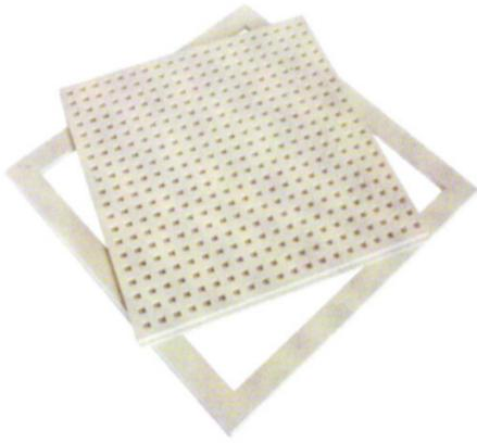
Trappe de visite pour plaque Gyptone® Activ'Air® Line 6. Le système est composé : d'une trappe de 510 x 510 mm avec décor correspondant, permettant le passage d'un homme ; d'un cadre support en plaque de plâtre de 600 x 600 mm.
